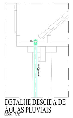
DETALHE DESCIDA DE ÁGUAS PLUVIAIS
